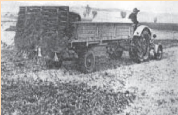
Fig. 9 – Tractor com um distribuidor de estrume accionado pela tdf
